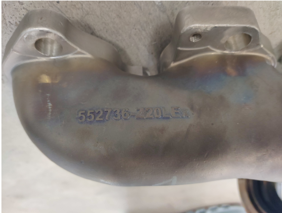
Kennzeichnung Abgaskrümmer Klasen Motors, Typ „552736-Z20LEx“
